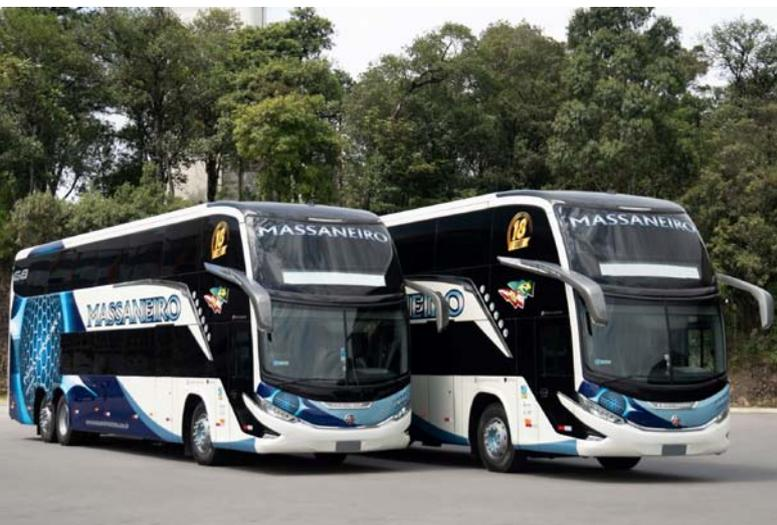
**Os novos ônibus Paradiso G8 1800 DD têm chassi Scania K400B 6x2**
