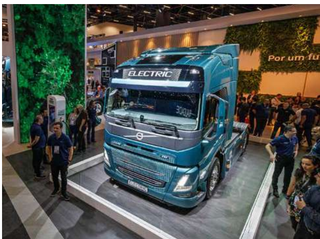
O caminhão elétrico FM Electric com opções de até 44 toneladas de PBTC tem autonomia de 300 quilômetros
